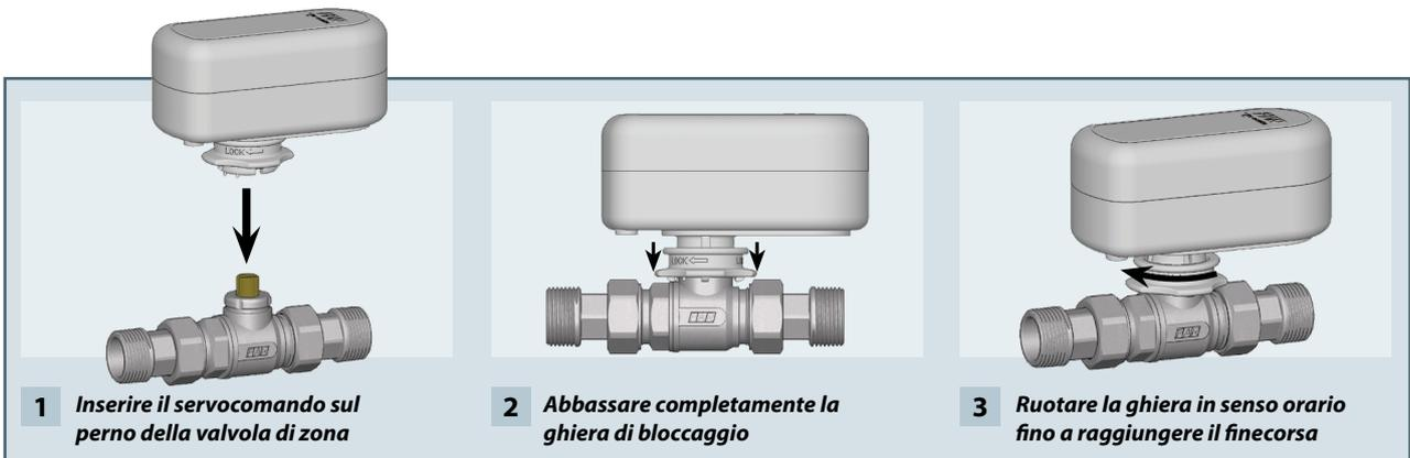
Il motore può essere installato sulla valvola in due diverse posizioni senza alcuna differenza, in quanto il movimento di 90° trasmesso alla valvola resta sempre lo stesso.
